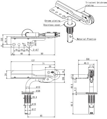
\* THIS DRAWING SHOWS THE MODEL FOR THE RIGHT . THE MODEL FOR THE LEFT IS SYMMETRICAL .
